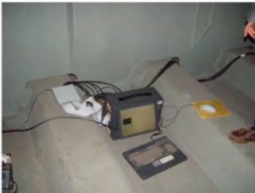
Un PC dans un pont gérant 8 capteurs (seulement).
