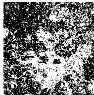
i) Image h après traitement du bruit : détection des moisissures
